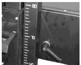
Оптические камеры регулируются по высоте с помощью слайдов на точных, бесшумных, пластиковых полозьях, на колонке помеченных сантиметровой шкалой для точного позиционирования относительно фар.
