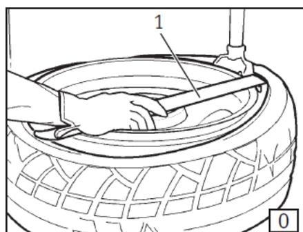
**Примечание:** чтобы избежать защемления камеры рекомендуется проделывать данную работу при положении клапана на приблизительно 10 см справа от монтажной головки. Держа рычаг в том же положении вращать поворотный стол (2, рис. L) **по часовой стрелке**, держа педаль (1, рис. L) нажатой, до тех пор, пока покрышка полностью не выйдет из обода. Чтобы избежать риска раздробления, держать руки и другие части тела как можно дальше от монтажной головки во время вращения поворотного стола.
