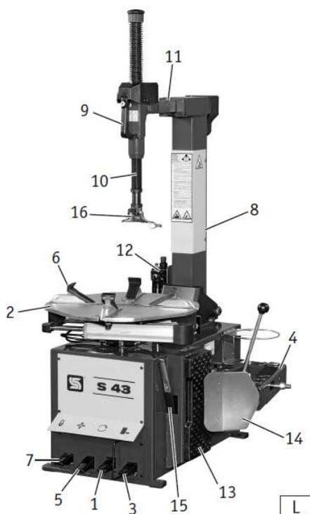
При блокировке ни в коем случае не держать руки на шине. Для правильной блокировки установить колесо точно в центр поворотного стола (2, рис. L). Проверить, чтобы колесо правильно блокировалось 4-мя зажимными кулачками.
